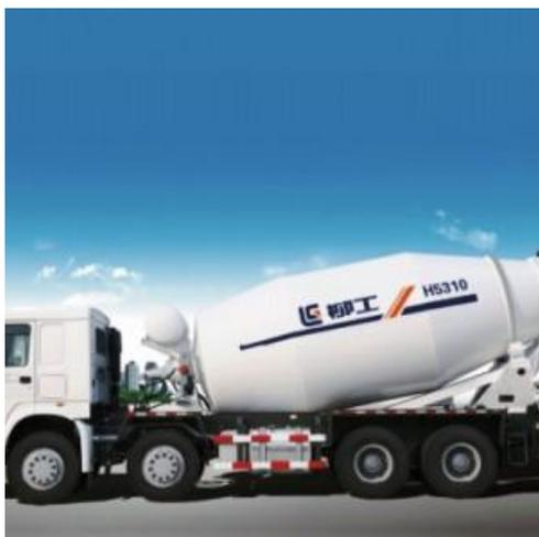
Специальная дорожно-строительная техника LiuGong, автобетоносмеситель YZH5310GJBHW с мощностью двигателя 247 kW, объемом смесительного барабана 18,9 м<sup>3</sup>, гидронасосом Sauer SPV2/089, объемом гидравлического бака 20 L предназначен для строительных работ на любой местности.
