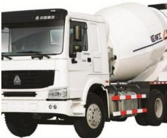
Специальная дорожно-строительная техника Liugong, автобетоносмеситель YZH5252GJBHW с мощностью двигателя 247 kW, объемом смесительного барабана 18.9 м<sup>3</sup>, гидронасосом American SAUER объемом гидравлического бака 20 L предназначен для строительных работ на любой местности.
