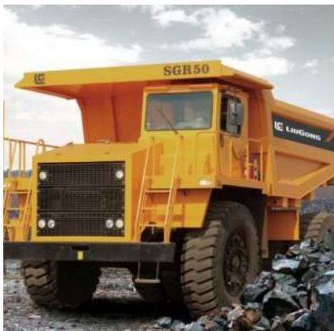
Специальная дорожно-строительная техника Liugong, карьерный самосвал SGR50 с грузопоемностью 45,000 kg, максимальной скоростью 56 km/h предназначен для строительных работ на любой местности.
