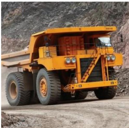
Специальная дорожно-строительная техника LiuGong, карьерный самосвал SGE190AC с грузопъемностью 172,000 kg, максимальной скоростью 40 km/h предназначен для строительных работ на любой местности.
