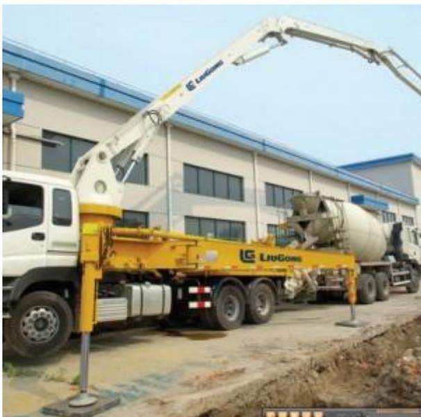
Специальная дорожно-строительная техника Liugong, бетононасос-кран HDL5270THB с мощностью двигателя 265 kW, макс. производительностью бетона 120 м<sup>3</sup>/ч, максимальной подачей по вертикали 36.8 м, максимальной подачей по горизонтали 32.8 м предназначен для строительных работ на любой местности.
