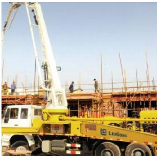
Специальная дорожно-строительная техника LiuGong, бетононасос-кран HDL5260THB с мощностью двигателя 198 kW, макс. производительностью бетона 120/70 м<sup>3</sup>/ч, максимальной подачей по вертикали 36.8 м, максимальной подачей по горизонтали 32.8 м предназначен для строительных работ на любой местности.
