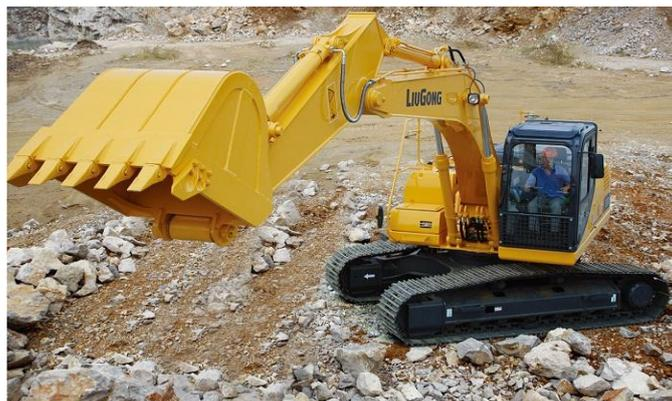
Модернизированная модель экскаватора CLG 920 D массой 20500 кг и объемом ковша 0,73-1 м<sup>3</sup>. В экскаваторе CLG 920 D появился ряд особенностей, поднявших данную модель на новый уровень. Претерпели изменения системы управления двигателем, усилены все рабочие элементы. По содержанию вредных веществ в выбросах отвечает требованиям Tier 2/ Euro II.
