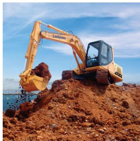
Масса машины составляет 13,5 тонн, объем ковша 0,55 м<sup>3</sup>. Небольшие габариты экскаватора позволяют ему работать в зданиях и сооружениях, как при их постройке, так и при разрушении. В базовом варианте экскаватор CLG 915C оснащен гидравлической разводкой для подключения навесного оборудования.
