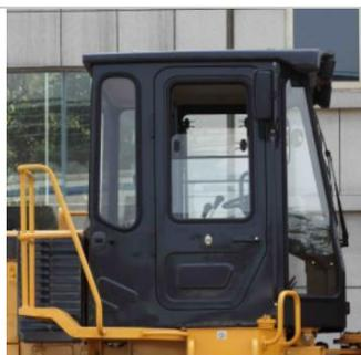
Площадка большой площади при выходе из кабины и ступени с противоскользящим покрытием обеспечивают безопасное попадание и выход из кабины.
