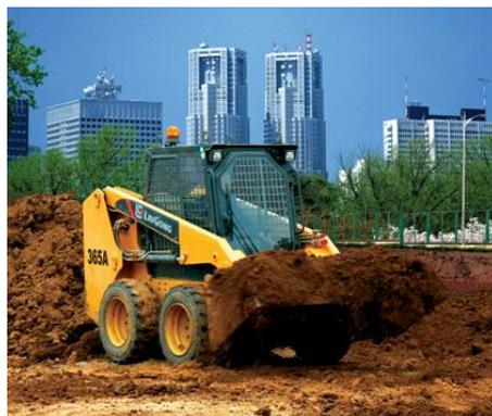
Универсальный погрузчик LiuGong CLG 365 A (аналог Bobcat S 175, 220) имеет большой перечень быстросменного навесного оборудования. Отличается мощным двигателем (68 л.с.), а также высокой маневренностью и производительностью, просторной и удобной кабиной. По содержанию вредных веществ в выбросах отвечает требованиям Tier 2/Euro II.
